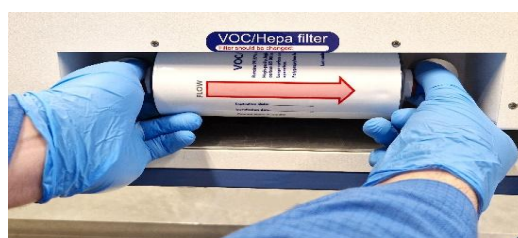
Abbildung 12.2 Verfahren zum Einsetzen und Entfernen des LCKW/HEPA-Filters
